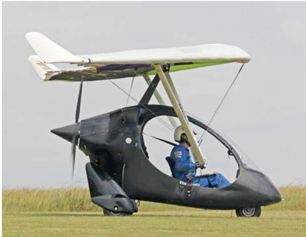
Avec sa coque aérodynamique autoportante unique, en fibres de carbone /infusion, pour donner plus de solidité, de protection passive et de rigidité, pour un poids minimal, le **PulsR** enfonce une porte, vers une nouvelle génération d'ULM. Le train principal du **PulsR** est de type Cantilever, composite, combiné avec de grandes roues et pneus de toundra permettant d'aborder les terrains les plus rudes.
