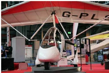
auto-portante, volumineuse, pour une protection passive optimale. Un pare-brise protecteur "enveloppant" assure un vol de croisière, sans effort, à 152 km/h et sans être dérangé par les turbulences en cabine. Les sièges larges du **PulsR** sont complètement réglables pour tous gabarits de pilotes. Réservoir d'essence de 80L pour de longues navigation, sans souci permanent de refueling. Le **PulsR** est surmonté de la toute nouvelle aile GTR (13m<sup>2</sup>) sans mât et haubans rigides,
